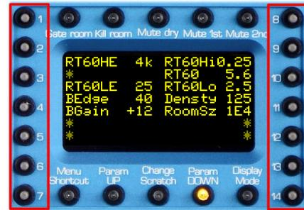
Fig. 33: Toggle keys 14 parameters
