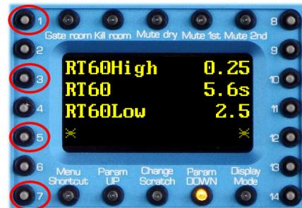
Fig. 34: Toggle keys 4 parameters
