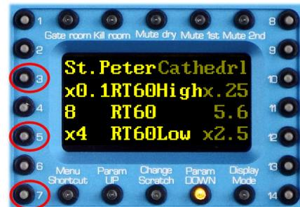
Fig. 36: Toggle keys 3 parameters
